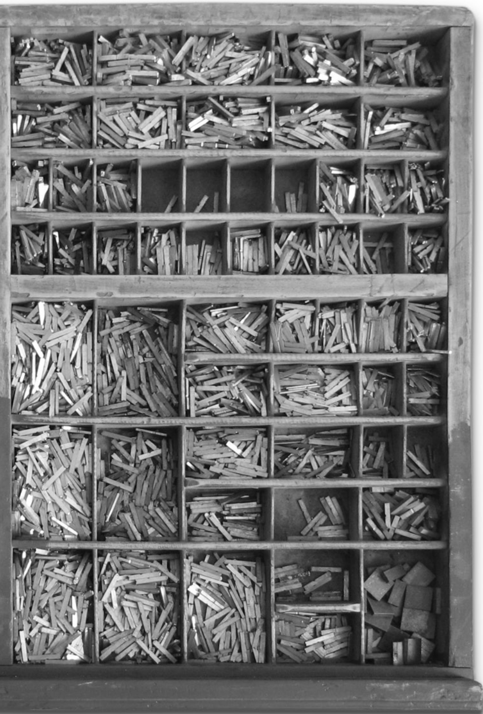
Наборная касса. В верхней части находятся прописные знаки, в нижней — строчные
